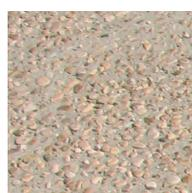
**Le béton désactivé**, sous réserve que les agrégats entrant dans sa composition soient constitués d'un mélange de granulats de Loire (rosés) et de quartz (blanc), afin que la teinte du revêtement s'harmonise avec l'architecture. Les agrégats seront de préférence de très faible granulométrie.
