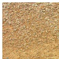
**Les stabilisés** (sables ou graves, agglomérés par compactage avec ou sans liant, chaux, sel, à l'exclusion du ciment. Les stabilisés avec liant offrent une meilleure tenue dans le temps et autorisent un usage sur terrain présentant une pente jusqu'à 15%.
