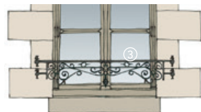
> MAISON DE BOURG - FENETRES 1_Vantail divisé en trois carreaux 2_Petit bois 3_Garde-corps ouvré
